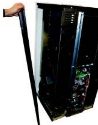
Fig. 46 - Desmontaje de la pared lateral
