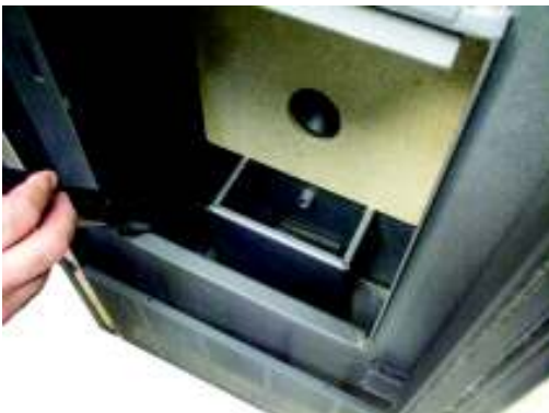
Fig. 41 - Limpieza alojamiento brasero
