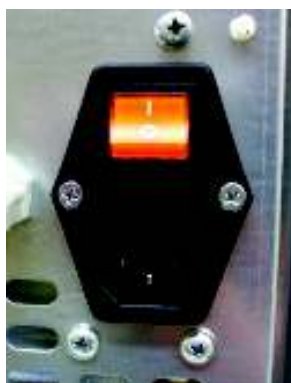
Fig. 26 - Toma de corriente con interruptor general
