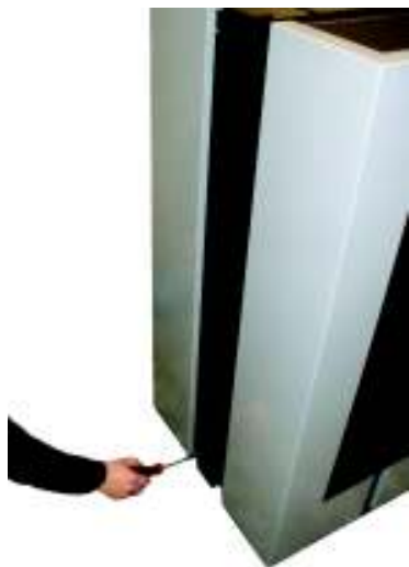
Fig. 47 - Extracción tornillos inferiores
