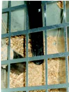
Fig. 39 - Limpieza depósito y coclea
