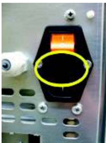
Fig. 49 - Ventanilla con los fusibles de remover
