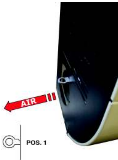
Fig. 22 - Posición de la palanca para desviar el aire: pos. 1
