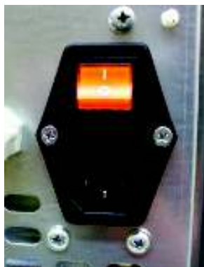
Fig. 20 - Toma de corriente con interruptor general
