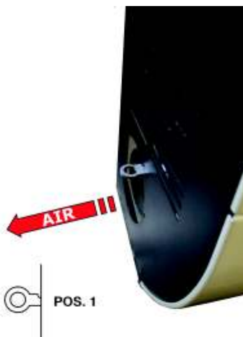
Fig. 29 - Posición de la palanca para desviar el aire: pos. 1
