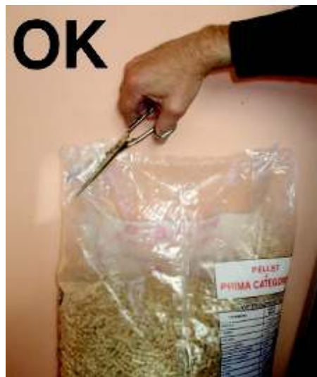
Fig. 32 - Abertura correcta del saco del pellets
