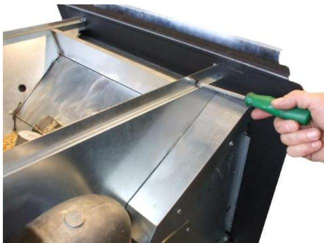
Fig 49 - Svitare viti di fissaggio carter
