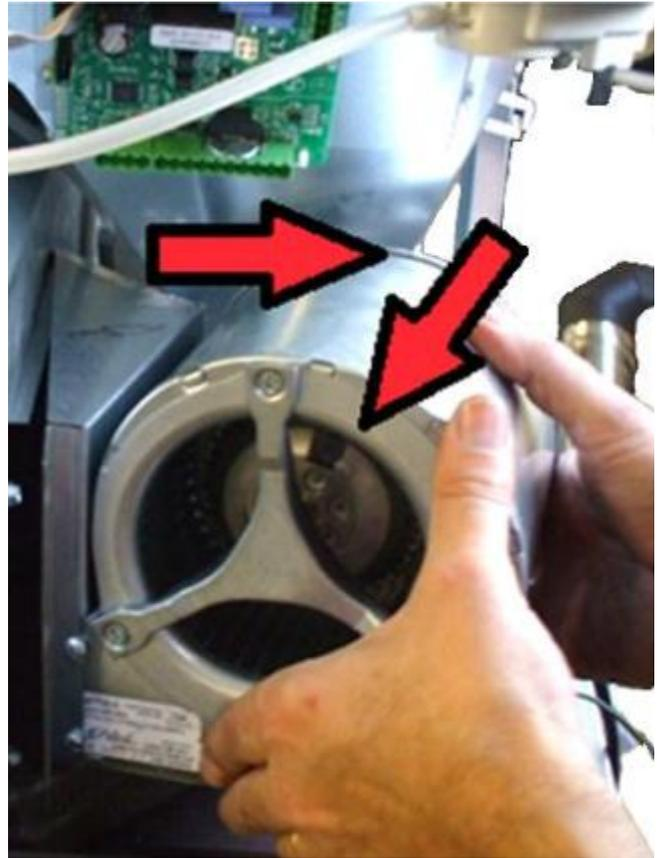
Fig 52 - Rimozione del ventilatore
