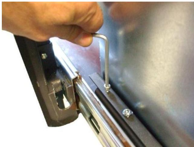
Fig 16 - Vite posteriore di fissaggio inserto
