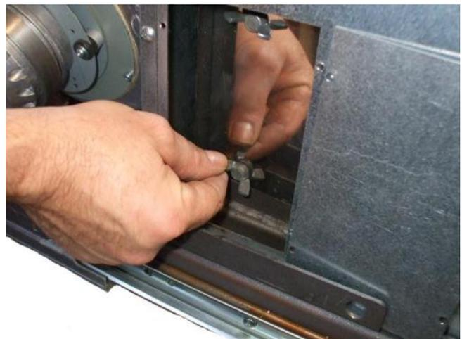
Fig 43 - Rimozione 2° pannello
