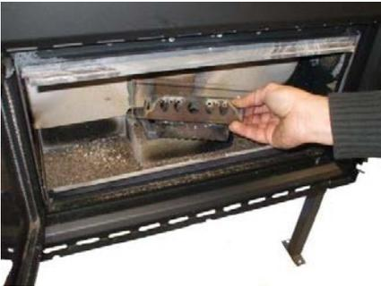
Fig 30 - Rimozione braciere
