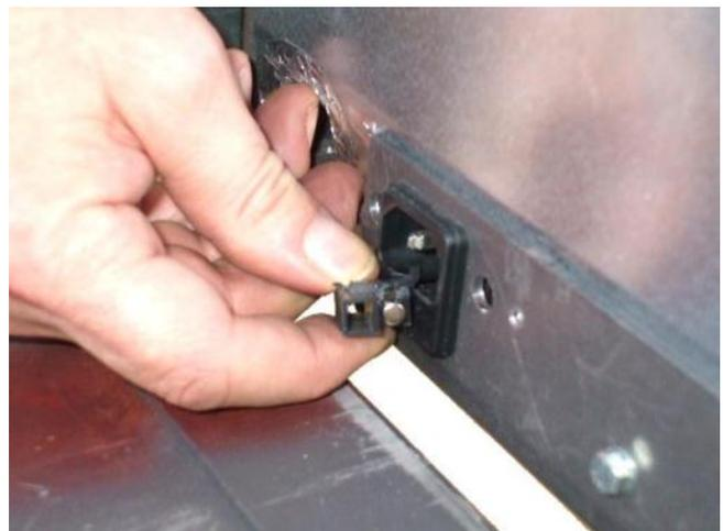
Fig 54 - Sostituzione del fusibile
