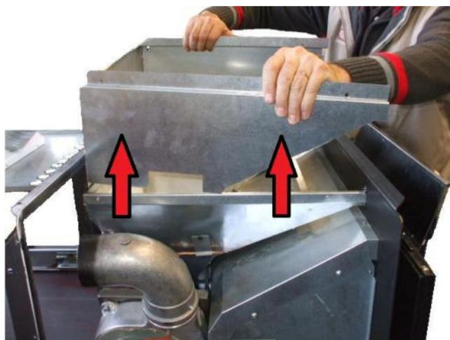
Fig 50 - Rimozione carter
