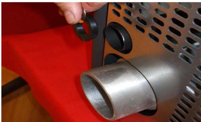
Mediante un tapón de 40mm si observamos que la llama es débil y de color amarillo significa que le falta aire con lo cual se debe abrir el registro.
