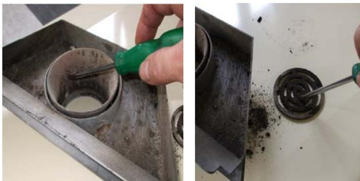
La cenizas depositada en el cajón metálico debe ser vaciada pero no debe tener contacto con materiales combustibles (por ejemplo suelo de madera) debido a que la ceniza depositada aún puede tener temperatura.
